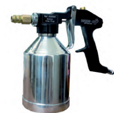
1 pistolet de pulvérisation 12 bar (175 psi) avec son godet de 800ml
